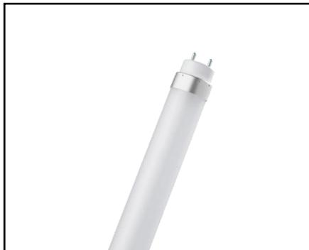
Innovative SELV LED-Lampe mit hoher Helligkeit und externem EVG. Einfache und sichere Verwendung in Langfeldleuchten. Spart als Ersatz für 0.6 m T8 Leuchtstofflampen mehr als 60% Energie mit 2-stufiger DIM Funktionalität. Volle Helligkeit ohne Aufwärmphase und Flackern. Kein Quecksilber.
